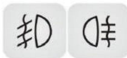
Cuando la perilla de la luz está en la posición de luz pequeña, la perilla de la luz antiniebla se puede girar 30° en sentido antihorario a la posición de la luz antiniebla delantera y la luz antiniebla delantera se encenderá; seguir girando la perilla de la luz antiniebla 30° en sentido antihorario (reinicio automático), y la luz antiniebla trasera se encenderá;
