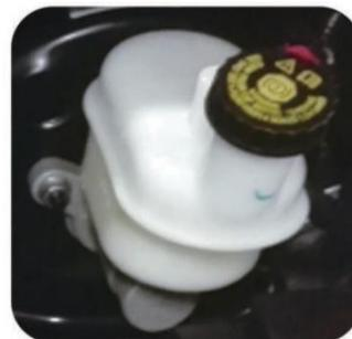
Modelo del líquido de freno: líquido de freno sintético DOT4.
