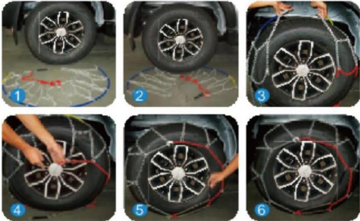
1. Pavimente la cadena antideslizante planamente sobre el suelo, el extremo final de plástico amarillo de la cuerda de alambres de acero mira hacia el lado izquierdo. (Figura 1)
