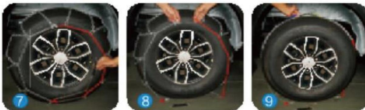
1. Estacione el vehículo, deje que el gancho de sujeción blanco se encuentre en la parte superior del neumático, suelte el gancho de goma, primero tire de la cadena de bloqueo roja desde el collarín rojo, luego tírela hacia afuera desde el gancho de sujeción rojo. (Figura 7)
