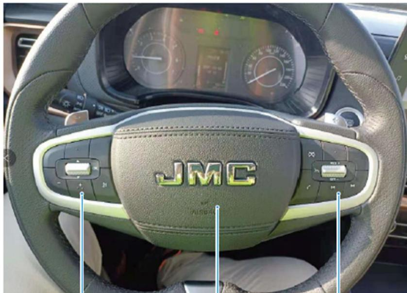
Interruptor de control de instrumento combinado y control de audio
