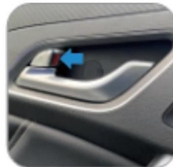
Cada puerta de pasajeros puede realizar el bloqueo y desbloqueo manual por separado. Cuando se realiza el bloqueo y desbloqueo a través del botón de bloqueo mecánico, el intervalo entre cada paso de bloqueo o desbloqueo debe ser por lo menos 0,6S, el intervalo recomendado es 1S.
