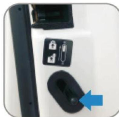
Si no se sigue el procedimiento normal de abrir puertas en el vehículo, es posible que la fuerza de operación del botón de desbloqueo manual de la puerta de pasajeros aumente drásticamente. Entonces, pueden eliminar las anomalías mediante las siguientes operaciones:
