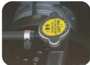
Puerto de inyección de refrigerante
