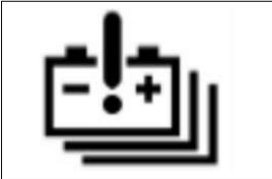
**Luz indicadora de avería de la batería de tracción**
