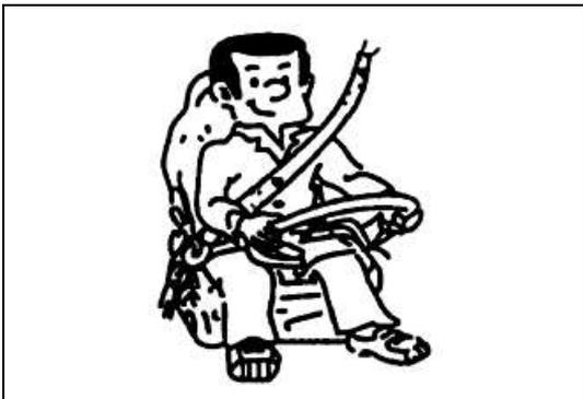
1. Ajuste el asiento a una posición con la que el conductor se sienta cómodo. Y la parte superior del cuerpo debe estar cerca del respaldo cuando esté sentado en el asiento.
