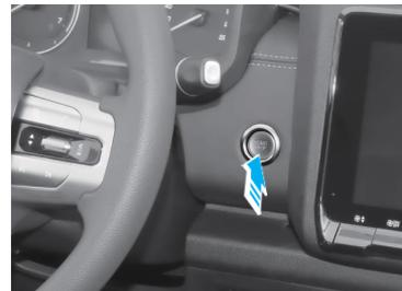
El interruptor de arranque con un botón está ubicado en el panel del salpicadero, en la parte inferior derecha del volante.
