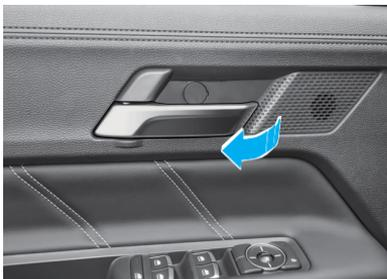
Cuando la cerradura de puertas de control central del vehículo está bloqueada, tire de la manija interior de la puerta delantera para desbloquear la puerta delantera y abrirla. Es necesario tirar dos veces de la puerta trasera para desbloquear y abrirla (tire una vez para desbloquear la puerta trasera, tire dos veces para abrirla).
