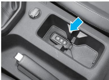
Cuando la batería de la llave inteligente está agotada o baja, coloque la llave inteligente o la llave mecánica en la posición del icono en la caja del apoyabrazos.
