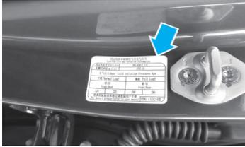
La etiqueta que indica los datos de presión de los neumáticos se encuentra en el pilar B en el lado del conductor.
