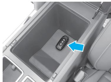
Cuando la batería de la llave inteligente está agotada o baja, coloque la llave inteligente o la llave mecánica en la posición central del primer portavasos, como se muestra el icono.
