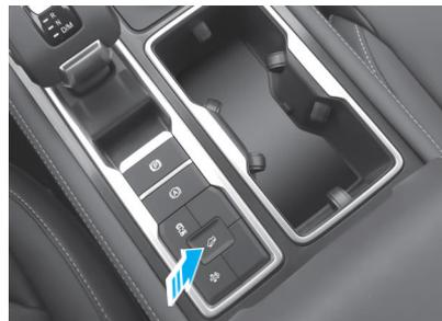
Cuando la velocidad es inferior a 60 km/h, la función de control del descenso suave de pendiente pronunciada se puede activar presionando el botón en la consola central. En este momento, se encenderán la luz indicadora del botón se encenderá y la luz indicadora del descenso suave de pendiente pronunciada
