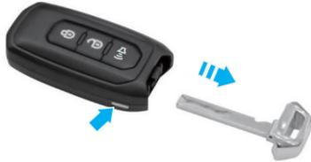
Presione el botón de bloqueo en el costado de la llave para extraer los dientes de la llave mecánica hacia afuera.
