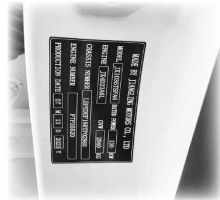
Las placas de productos del vehículo con el código de identificación del vehículo y la masa total máxima permitida se encuentran en la columna neutra del lado del pasajero delantero.
