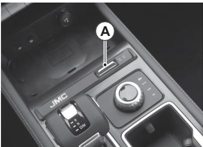
La perilla de control tipo eléctrico del bloqueo del diferencial A está ubicada en la parte delantera derecha de la palanca de cambios del cambio de velocidades.
