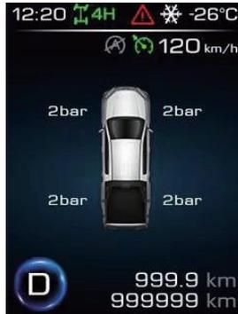
Muestra la presión de cada neumático y el estado de alarma de los neumáticos, cuando se emite alarma, se enciende la luz de advertencia de avería de la presión de neumáticos en el salpicadero
