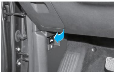
1. Tire de la palanca de liberación de la tapa del compartimento en la parte inferior izquierda del salpicadero y el capó del motor se desbloqueará y abrirá.
