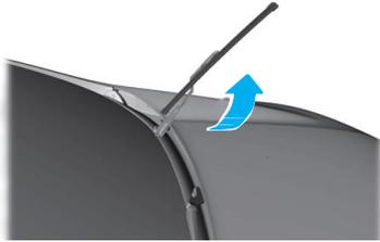
2. Use una toalla gruesa en el parabrisas en la parte inferior del brazo del limpiaparabrisas para evitar que el rebote accidental del brazo del limpiaparabrisas dañe el parabrisas, y luego levante completamente el brazo del limpiaparabrisas;
