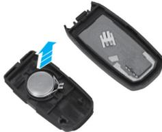
4. Retire la batería del control remoto del cuerpo de la llave;
