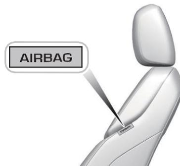
Los airbags laterales están situados en el interior del respaldo de los asientos delanteros. La etiqueta en el respaldo indica si el vehículo está equipado con airbags laterales o no.
