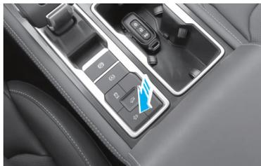
El botón de regeneración de DPF está ubicado en el panel de interruptores detrás de la palanca de cambios del cambio de velocidades.
