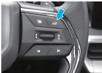
Presione y suelte este botón para activar o desactivar el control por voz. Cuando llegue una llamada telefónica por Bluetooth, presione brevemente este botón para responder y mantenga presionado este botón para colgar; durante una llamada telefónica por Bluetooth, presione brevemente este botón para colgar.
