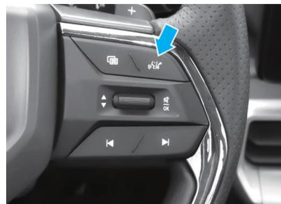
Presione y suelte este botón para activar o desactivar el control por voz. Cuando llegue una llamada telefónica por Bluetooth, presione brevemente este botón para responder y mantenga presionado este botón para colgar; durante una llamada telefónica por Bluetooth, presione brevemente este botón para colgar.
