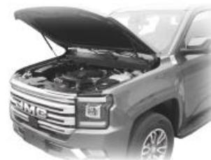
3. Cuando el capó del motor se levanta unos 40 cm, el capó del motor se abre de forma totalmente automático.
