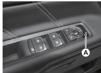
**A Desbloqueo/bloqueo - Al presionarlo, la luz indicadora al lado izquierdo del botón se apagará y se desbloquearán todas las puertas; al presionarlo otra vez, la luz indicadora al lado izquierdo del botón se encenderá y se bloquearán todas las puertas;**
