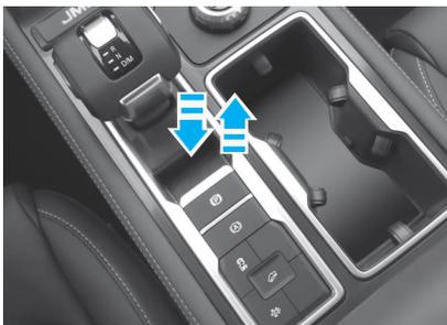
El interruptor del freno de estacionamiento electrónico (P) está ubicado detrás de la perilla del cambio de velocidades.
