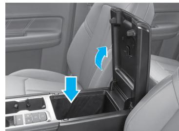
Abroche el extremo frontal de la tapa del guardaobjetos central, levántela hacia arriba para abrirla hasta unos 90° y podrá ver el guardaobjetos central.
