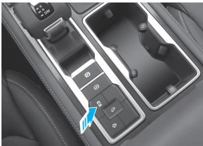
En ciertas condiciones (cuando el vehículo arranca sobre barro, nieve o una superficie de carretera blanda), cuando es necesario apagar la función ESP, puede presionar el botón ESP OFF en la consola central y la luz indicadora de apagado de ESP en el salpicadero 🚨 se iluminará.
