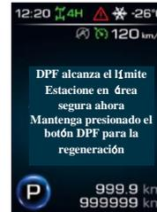
Estacione el vehículo en un área segura que no sea propensa a incendios, encienda el vehículo y manténgalo en ralentí active el freno de estacionamiento, cambie la marcha a la neutral y asegúrese de que la temperatura del agua supere los 60 °C. Mantenga presionado el botón de regeneración de DPF detrás de la palanca de cambios del cambio de velocidades hasta que la velocidad rotativa del motor aumente antes de soltarlo.
