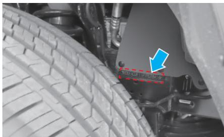
El número de identificación del vehículo está grabado en la viga longitudinal delantera derecha, que es visible desde la parte delantera de la rueda delantera derecha.
