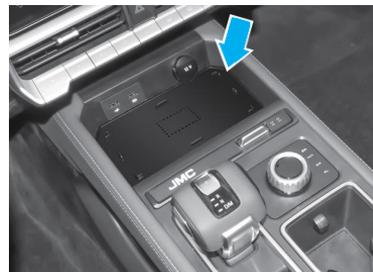
El panel de carga inalámbrica está ubicado en la parte delantera de la consola central.
