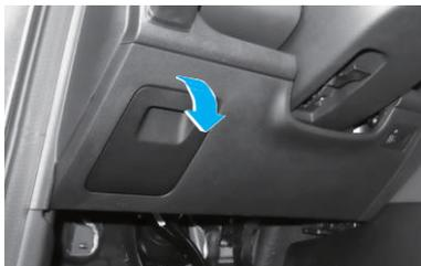
Retire la cubierta en la parte inferior izquierda del salpicadero para ver la caja de fusibles de la cabina.
