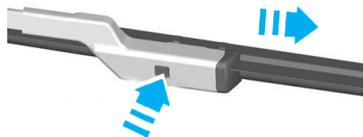
3. Presione el botón de bloqueo de la escobilla del limpiaparabrisas mientras sostiene la escobilla del limpiaparabrisas y saque la escobilla del limpiaparabrisas un poco más fuerte en la dirección de la flecha;
