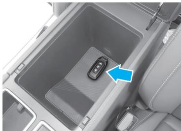
Cuando la batería de la llave inteligente esté agotada o baja, coloque la llave inteligente o la llave mecánica en la posición del icono en la caja del apoyabrazos.
