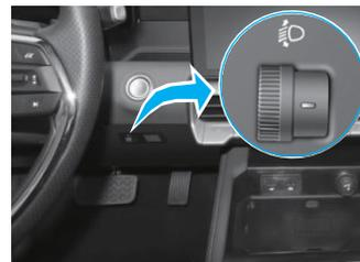
Con el interruptor de arranque con un botón en el modo "ON", cuando los faros delanteros están encendidos, el conductor puede ajustar la altura de ellos girando la rueda de ajuste manual ubicada en el centro izquierdo del salpicadero.
