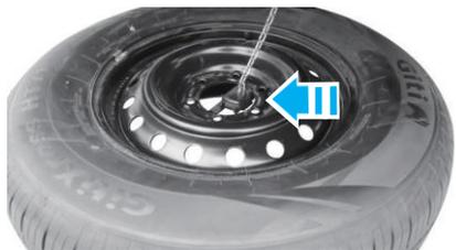
3. Pase el soporte y el pestillo a través de la abertura del neumático de repuesto como se muestra arriba, y retire el neumático de repuesto y la paleta del neumático de repuesto.
